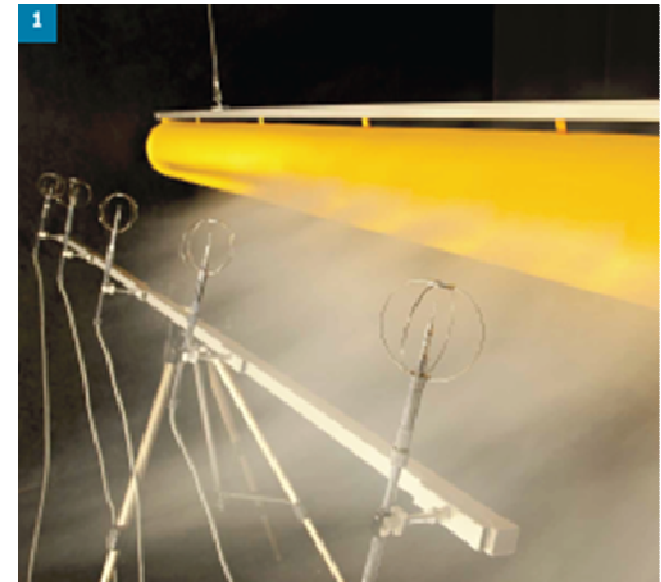
Messung der Luftgeschwindigkeit mit Anemometern
