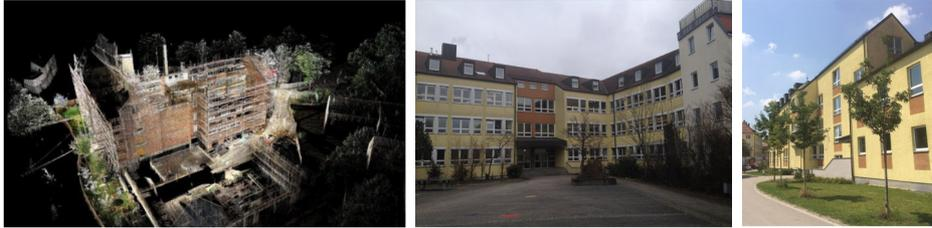
Vermessung mittels einer Punktwolke. Eine Punktwolke ist die Ansammlung von Millionen von Einzelmessungen einer zuvor definierten Umgebung beziehungsweise eines Objekts. Die Punktwolke ist dabei häufig das Ergebnis einer 3D-Vermessung. (Foto: Gump & Maier)
